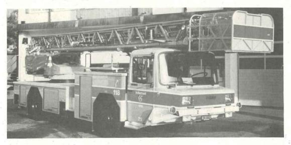
Die Autodrehleiter kann zur Personenrettung und zu Löschzwecken eingesetzt werden. Der am oberen Ende der Leiter angebrachte Korb erleichtert den Einsatz bei Rettungen wesentlich. Die Leiter kann bis auf 30m ausgefahren werden, dabei überwacht die eingebaute Elektronik die Auslegung und den Anstellwinkel in Abhängigkeit der Last auf der Leiter.
