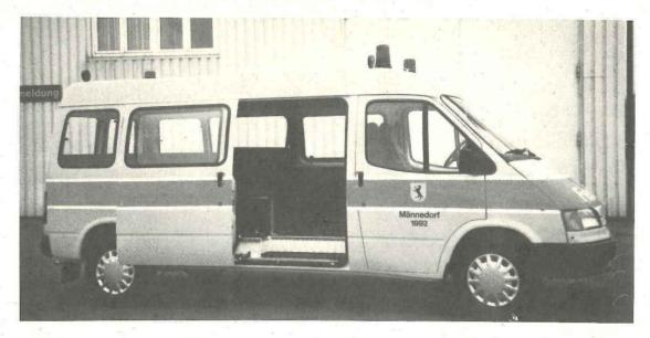
Mit diesem Fahrzeug können insgesamt 15 Personen transportiert werden. Das Fahrzeug ist mit einem Funkgerät und diversen Signalisierungsmaterialien und mit 6 Atemschutzgeräten sowie Atemluft-Reserveflaschen ausgerüstet.
