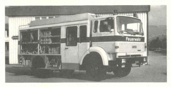
Das Tanklöschfahrzeug, welches Platz für 6 bis 8 Feuerwehrleute bietet, ist ein allradangetriebenes, geländegängiges Fahrzeug, mit einer Pumpe Typ III für Normal- und Hochdruck und mit einem Wassertank von mindestens 2400 Liter. Zur Ausrüstung gehört ein Mobilfunkgerät, ein Handfunkgerät, umfangreiches Löschmaterial, Atemschutzgeräte, Rettungsmaterial, Pionier- und Signalisationsmaterial, ein Generator und ein pneumatisch ausfahrbarer Lichtmast.
