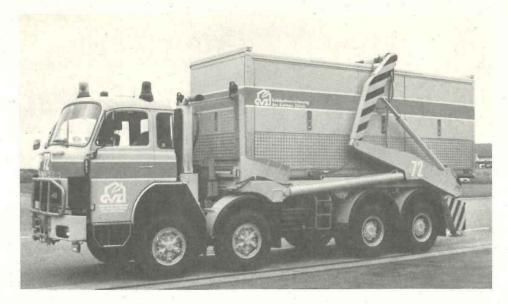
Der Schwenklader ist das Basisfahrzeug für eine Vielzahl von Containern. Der kantonale Stützpunkt verfügt über 3 solcher Fahrzeuge, mit verschiedenen Containern, insbesondere mit 4 Containern mit Schaummittel.
