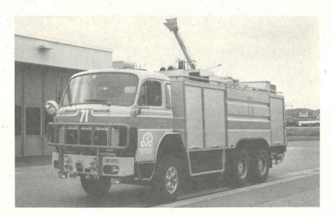
Dieses Spezialfahrzeug kommt bei Grossbränden zum Einsatz. Es steht ein Tank mit 5000 I Schaummittel und mit 2500 I Wasser zur Verfügung. Die eingebaute Pumpe liefert 6000 I/min bei 8 bar, was einen entsprechenden Wasseranschluss bedingt. Die Saughöhe beträgt 3 bis 4m und der Schaum-/ Wasserwerfer hat eine Reichweite von ca. 70m. Umfangreiches Schlauchmaterial gehört ebenfalls zur Ausrüstung.
