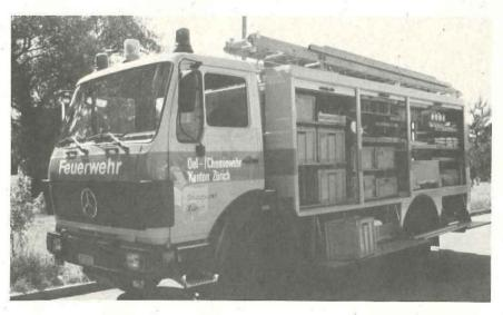
Auf diesem Fahrzeug befindet sich weiteres Oel-/Chemiewehrmaterial, das die Ausrüstung der Ortsfeuerwehr ergänzt bzw. erweitert. Insbesondere zusätzliche Atemschutzmasken, Augenduschen und spezielle Arbeits- und Schutzbekleidungen, diverse Messgeräte, Pumpen, Elektro- und Erdungsmaterial, umfangreiches Abdichtungsmaterial, spezielles Werkzeug, Absperrund Signalisationsmaterial und ein Lichtmast.
