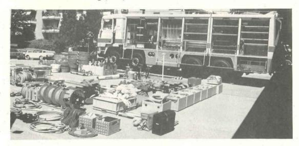
Das Universallöschfahrzeug kommt bei Grossereignissen zum Einsatz. Es hat 4 Achsen und wiegt 28t. Der Wassertank fasst 5500 bis 6000 Liter und der Schaummitteltank 1500 Liter (Pumpentyp IV). Die Pulveranlage fasst 2000kg Löschpulver. Zur Ausrüstung gehört ein Mobilfunkgerät, ein Handfunkgerät, einen pneumatisch ausfahrbaren Lichtmast, umfangreiches Atemschutz-, Rettungs-, Lösch,- Pionier-, Beleuchtungs- und Signalisierungsmaterial.
