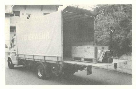
Dieses Fahrzeug hat eine Nutzlast von 2500kg und ist mit einem Mobilfunkgerät, einer hydraulischen Hebebühne für eine Nutzlast von 1000kg und mit Signalisierungsmaterial ausgerüstet.
